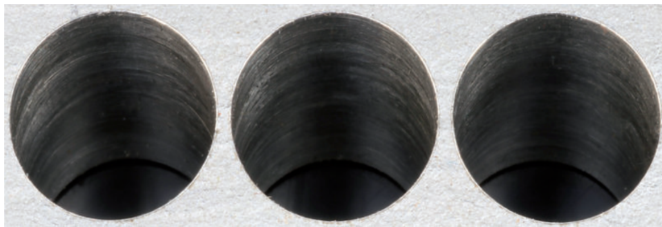
Obr. 4: Geometrie otvorů a kvalita jejich povrchu dosahuje velmi vysoké úrovně.
