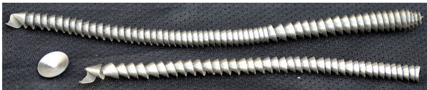
Obr. 3: Tvar, celistvost a kvalita povrchu třísky
